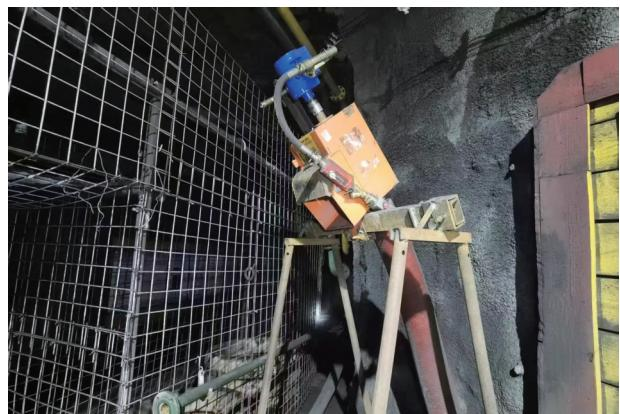
汾西矿业讯 近日,水峪煤业综掘队完成螺旋软管上料机改造项目,并在九采区皮带巷、回风巷喷浆作业中投入使用,显著提升了作业效率,降低了劳动强度,为井下喷浆作业提质增效提供了可靠保障。
