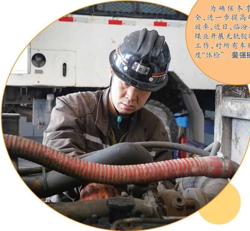
为确保冬季运输安全,进一步提高矿井运输效率,近日,临汾公司四通煤业开展无轨胶轮车保养工作,对所有车辆进行深度“体检”。裴强摄影报道
