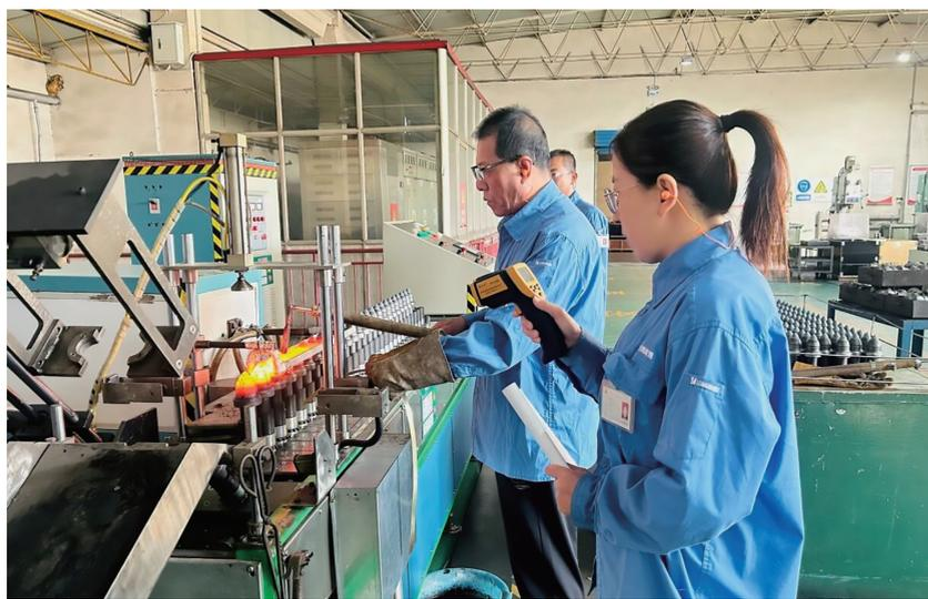
“叮当—叮当—”汾西矿业新产业物资销售公司截齿车间里,机器运转的轰鸣声与清脆的金属敲击声交织在一起,一派严谨专注的工作氛围扑面而来。9月5日,操作台前,该公司质检员陈晓云正手持游标卡尺,反复测量刚到货的截齿体的各种尺寸。她手边的检验记录表上整齐清晰地记录着:“原材料直径误差0.01毫米”“焊缝无肉眼可见裂纹”——这是该车间践行“为煤矿安全生产把好质量关”的真实缩影。
