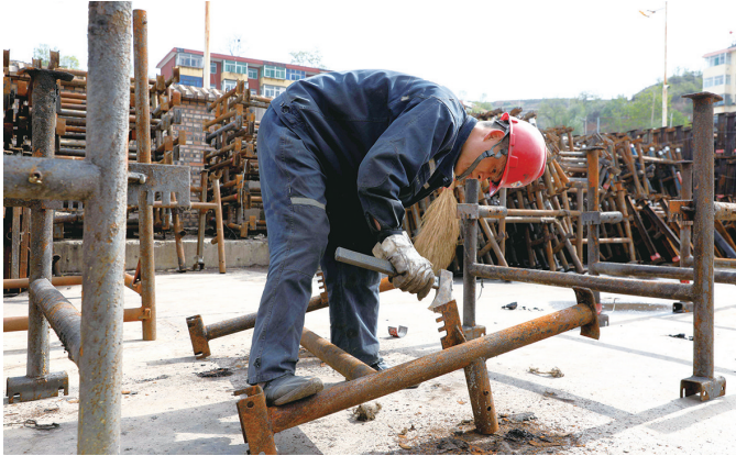
柳湾煤矿深入开展修旧利废工作,通过修复旧架、皮带管纵梁、托辊等部件,提升回收部件利用率,创造经济效益达200多万元。 高端婕 摄影报道
