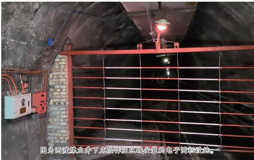
图为两渡煤业井下危险作业区域安装电子围栏设施。
