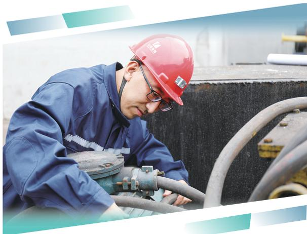
←高阳煤矿职工设计的《阻化剂喷洒注水泵技术改造》项目,获得了2022年汾西矿业精益现场改善提案一等奖。改造后既可以实现远距离喷洒,也可以放到综采工作面的设备列车上随采随移,不仅提高了工作效率,还降低了作业成本。目前,该设备在21106、31115综采工作面使用。
