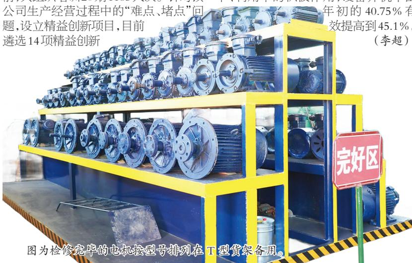
图为检修完毕的电机按型号排列在T型货架备用。
