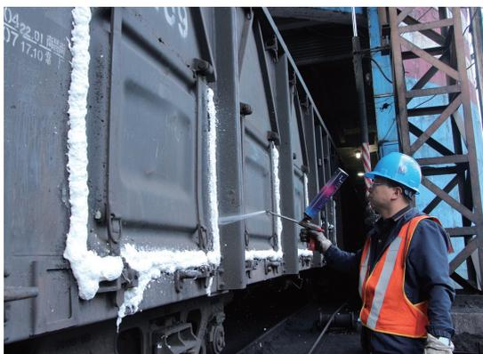
为加强煤炭铁路装车管理,确保在煤炭运输过程中不会对铁路沿线造成环境污染,今年以来,水峪煤业精心组织,紧密部署,对外运车皮进行全面检查维护,对车皮内外进行全面查漏,确保煤炭外运高效环保。图为水峪煤业铁路装运队职工采用聚氨酯泡沫胶对车皮缝隙进行喷胶密封。
