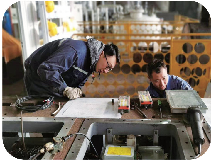
1月16日下午,设备修造厂电气装备车间突然接到任务,要求在最短时间内完成双柳矿MG400/940WD型一体式采煤机电控箱检测、维修、调试。该厂立即成立抢修小组,确定抢修方案,拆解、清理、机械检测、防爆检测、零部件检测更换、故障点记录维修。经过各项专业检测与维修,经过10余小时协作奋战,终于在凌晨两点圆满完成抢修任务。魏星 摄影报道
