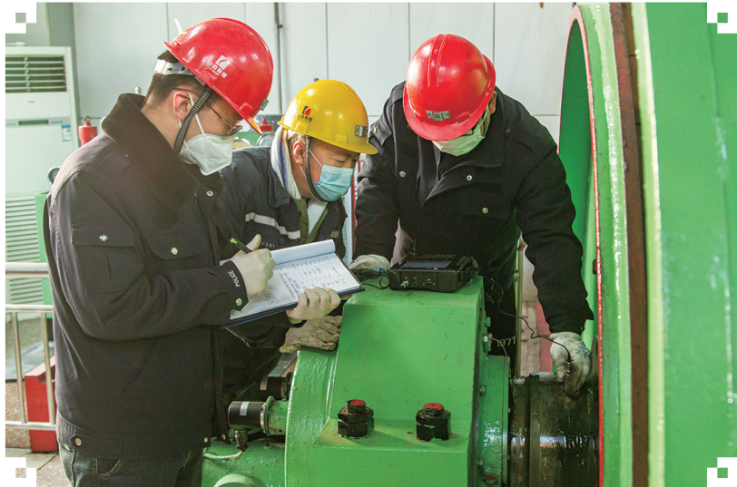
连日来,曙光煤矿深入学习贯彻山西焦煤、汾西矿业安全生产一号文件精神,开展机电运输专项整治行动,制定专项措施和整治方案,超前预判机电、运输设备等影响因素,定期组织对机电运输设备进行检修、维护,使设备始终处于良好的运行状态。图为设备队职工配合检测人员做副立井绞车主轴承探伤试验。 闫建伟 摄影报道
