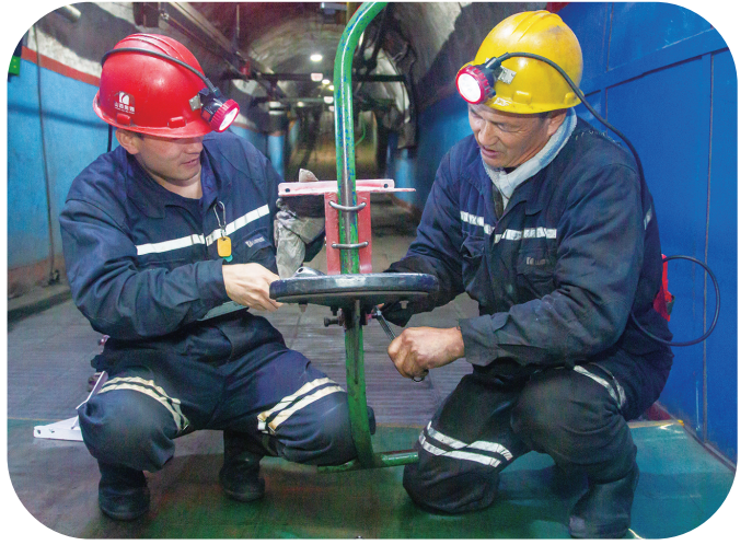
近日,曙光煤矿职工常有发明创造猴车座椅托物稳定架装置,将U型卡插入托物放置台总成的凹型卡座,与猴车连接用扳手拧紧螺母并锁紧。此装置减轻了职工上下班路中体力的消耗,提升了职工乘坐猴车的安全性。 闫建伟摄影报道
