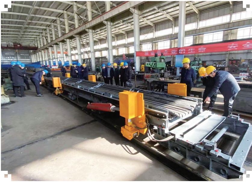
两渡煤业机修厂积极创新,反复摸索试验,利用推移油缸、抬底油缸、缓冲床、轨道等配件,完成了自移式皮带机机尾的初步设计制造。该设备结构简单、运行可靠、性能良好、操作灵活,能够以高压乳化液泵站为动力,实现迈步式快速自移,满足工作面高产高效快速推进的需要。目前,该设备已在21018运输巷投入使用。 郝芊葑 摄影报道
