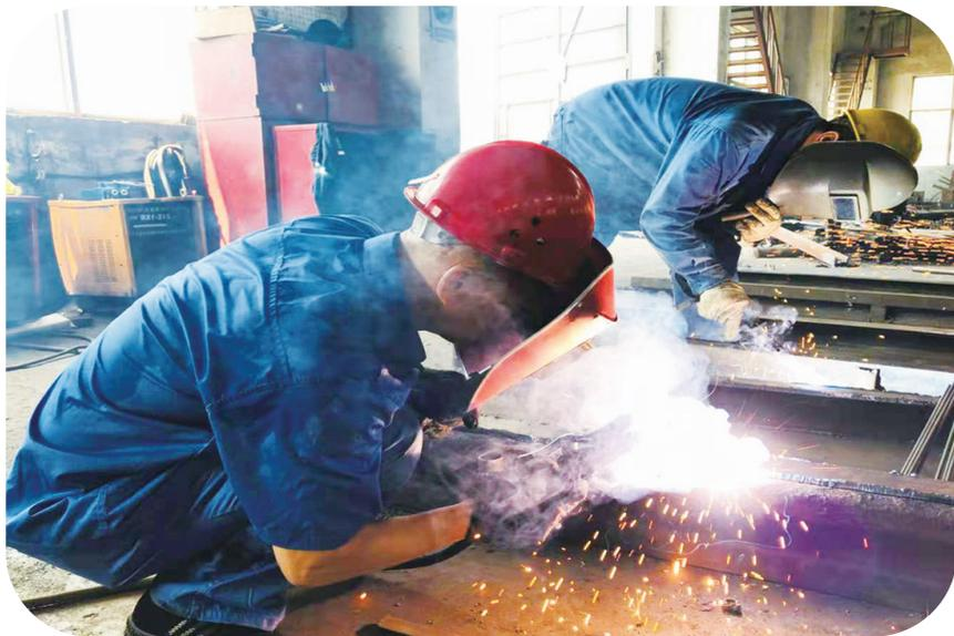
曙光煤业学习应用杜邦安全理念,用二氧化碳保护焊机对变形的连接杆进行焊接作业。改造后不仅能达到原有的支护强度,而且大大降低了生产成本。据悉,沿空留巷U型梁自主修复后为企业节约20余万元。
