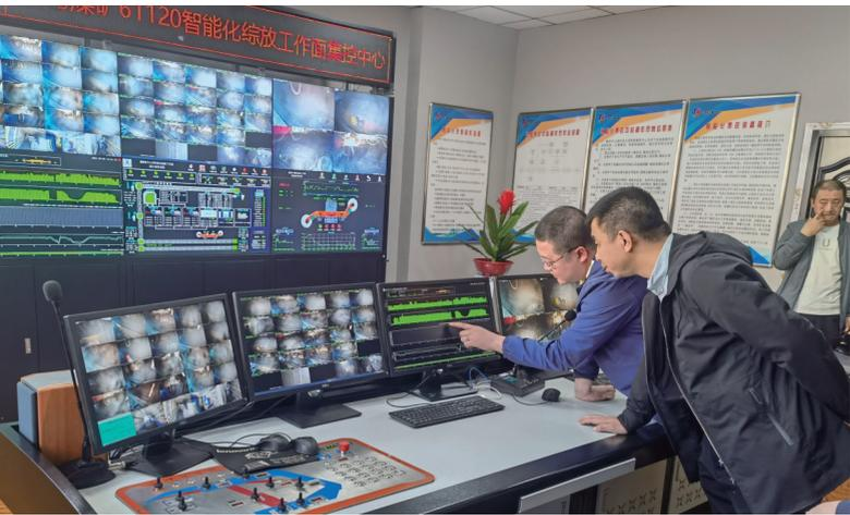
近日,曙光煤矿组织机电系统人员到柳湾煤矿,就井下智能化建设工作进行交流学习。大家参观了柳湾煤矿61120智能化工作面地面集控中心,现场观摩了采煤机记忆截割、液压支架自动跟机移架等工序,就成套智能化装备、远程控制技术、井下无线通信技术进行了交流探讨。
