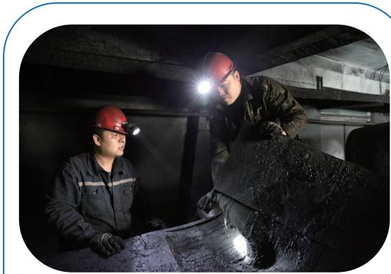
近日,高阳煤矿原煤准备车间对该车间皮带运输系统重点问题进行大检修。面对检修任务重、时间紧、难度大、地点分散等难题,该车间提前召开检修动员会,通过集思广益、集中研讨,最终确立了分组实施的方案。原煤车间401皮带为原煤输送皮带,带宽1.2米,带速3.15米/秒,皮带运距55米,此皮带使用已有一定年限,皮带工作面磨损严重。党员们纷纷主动请缨带头干,克服皮带长且重,作业空间狭小的状况,在不影响矿井正常生产的情况下,以最短的时间完成了更换任务,展示了该矿职工积极向上、敢于担当、勇往直前的精神风貌。
