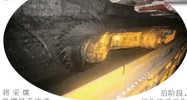
将采煤机惯导系统成功应用于工作面调直系统,将“平直”改为“斜直”,真正实现大落差两端头绝对距离差距大的工作面自动调直。该矿与集团公司设备修造厂合作研制的钱柱式自移设备列车机头,首次成功应用于高度3m以下的巷道,实现了现场遥控控制。
