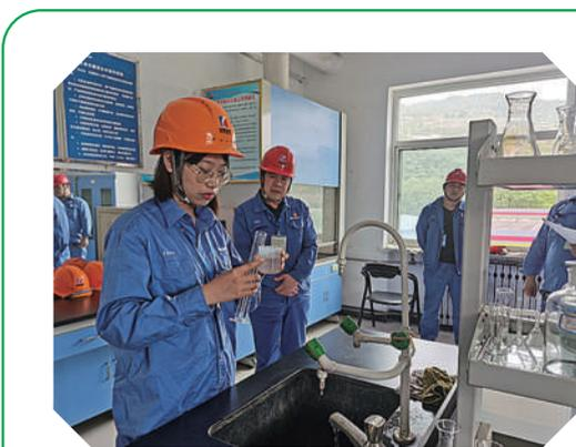
日前,为全面检验职工岗位技能水平与实际操作能力,发电厂开展了水处理岗位练兵活动。参赛选手们热情高涨,信心十足地进行了“手指口述”,在实践操作环节,大家从原理说明、使用HK-218型硅酸根分析仪器、添加试剂到水样显色、空白校准、水样测定都精细操作、全神贯注。评委组现场进行了公开、公平监督评分。
