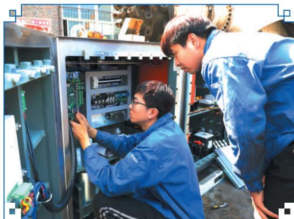
柳湾煤矿打好保生产“提前量”,近日,该矿机电科与厂家技术人员共同对胶带输送机变频器进行地面带负荷调试,确保该设备入井后可以投入使用,保证井下正常生产。图为工作人员正在调试设备。
